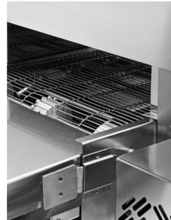
**Semplicità d'uso anche da personale non specializzato: una volta impostata la temperatura e la velocità del nastro trasportatore con il potenziometro basterà posizionare il prodotto sulla rete di trascinamento e a fine ciclo recuperarlo all'uscita della camera di cottura.**
